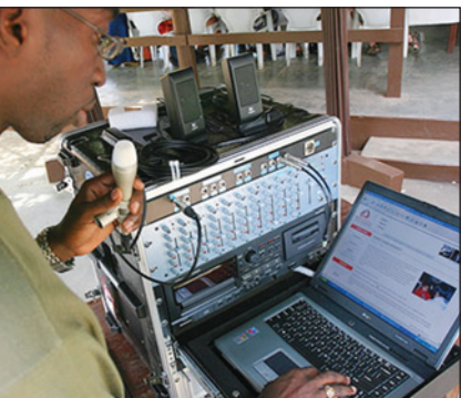
Radio-in-a-Box – пераносная радыёстанцыя для вяшчання ў раёнах стыхійных бедстваў і ў надзвычайных сітуацыях.
